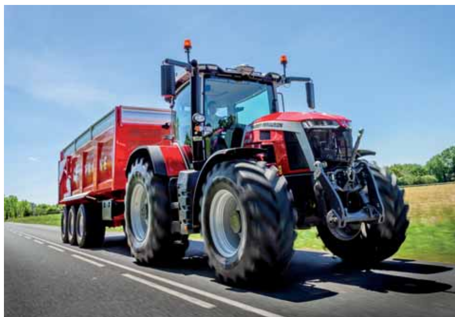
Plynulá Dyna-VT s prívlastkom Super Eco dosahuje maximálnu rýchlosť 40 km.h -1 pri otáčkach iba 1 450 min -1 .
