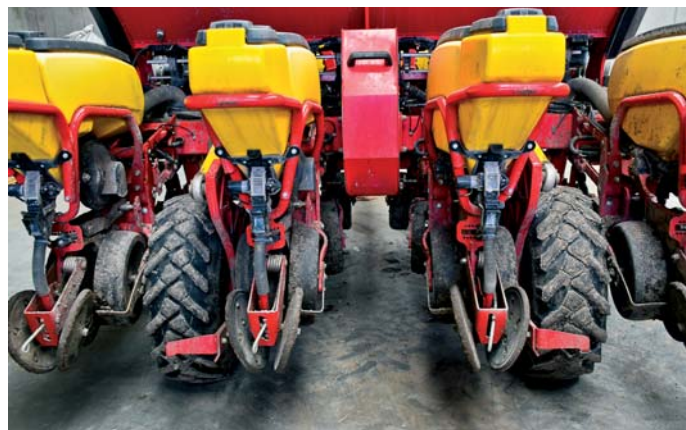
Prítlačné koliesá s jednoduchým nastavením do dvoch polôh a novšie rýchle prestavenie do piatich polôh. Ak sejete len kukuricu a slnečnicu, postačí to prvé jednoduchšie. Vyberáte jeden zo štyroch typov kolies.
