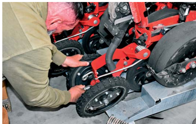
Prítlačné koliesá s jednoduchým nastavením do dvoch polôh a novšie rýchle prestavenie do piatich polôh. Ak sejete len kukuricu a slnečnicu, postačí to prvé jednoduchšie. Vyberáte jeden zo štyroch typov kolies.
