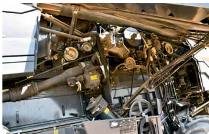
Pohon líšty je mechanický. Agco hovorí iba o malom počte servisných bodov a 13 remeňoch a jednej reťazi.
