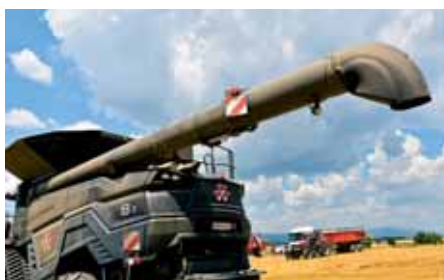
Závitovku podľa potreby vyberáte z troch dĺžok - 7,6; 9,15 a 10,6 metra. Vyprázdňovanie je možné v každej polohe.
