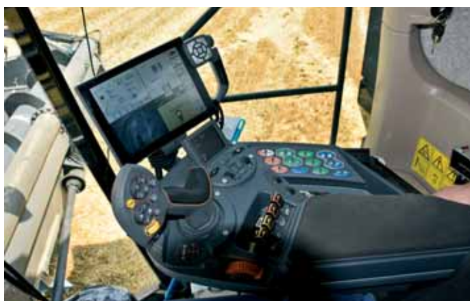
Hlavné ovládacie prvky. Dopĺňa ich prehľadný panel na ovládanie svetiel na streche kabíny.
